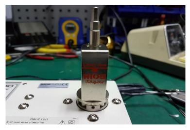
請注意鬆開扭力制具彈簧不能超過制具橘色線以上,再重複啟動電動起子測試扭力,
