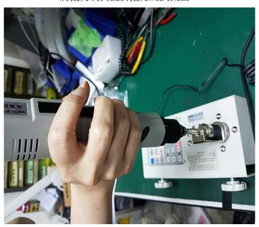
電動起子再直接套於扭力制具上,再啟動電動起子直到電動起子停止,顯示幕上會顯示停止的扭力,再反轉電動起子 鬆開扭力制具彈簧,記錄扭力值再 RESET 歸零
