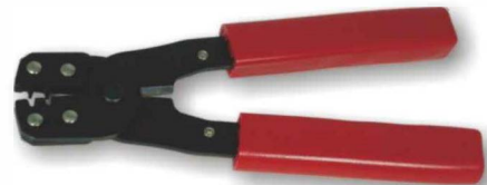
I 長度：175mm • D-Sub端子專用 • 亦可適用於杜邦2.54端子 • 附切斷功能 • 好握舒適把手
